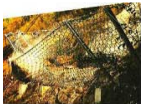
写真-1 落石防護ネット構造の野外実験状況
