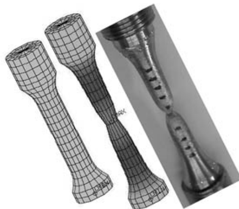
図12 載荷前および破断直後の解析結果と実験による破断後の試験片の変形形状比較
