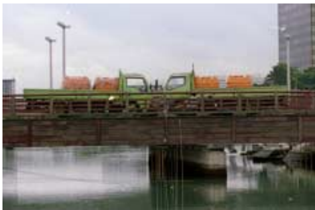
写真-1 車両載荷試験の様子
