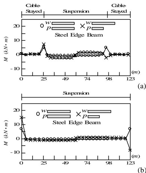
図-3 曲げモーメント特性(2鋼管構造)
