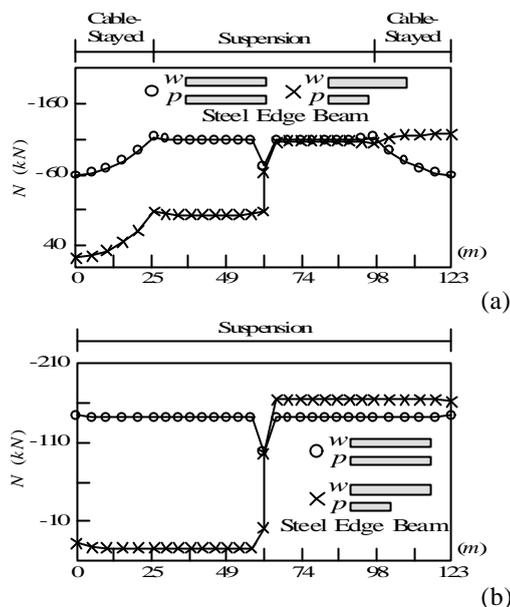
図-4 軸力特性（2 鋼管構造）
