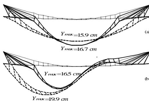
図-2 たわみ特性比較図(2鋼管構造)
