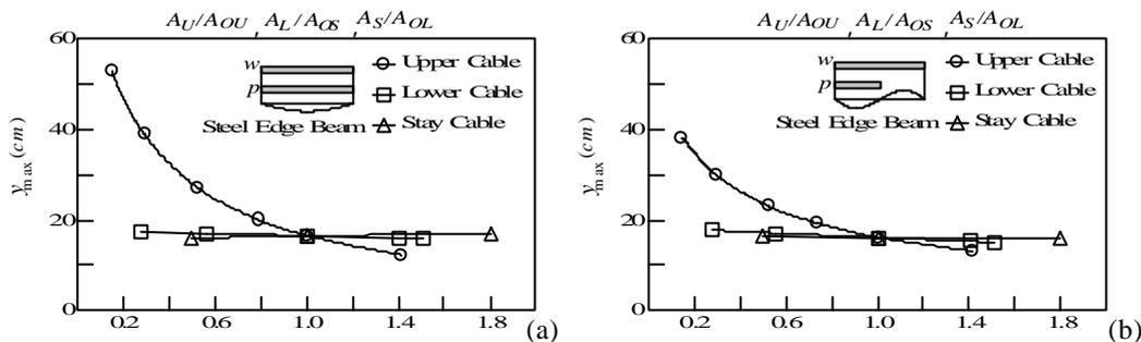
図-5 各ケーブルの断面積が  $y_{\text{max}}$  に及ぼす影響（2 鋼管構造）
