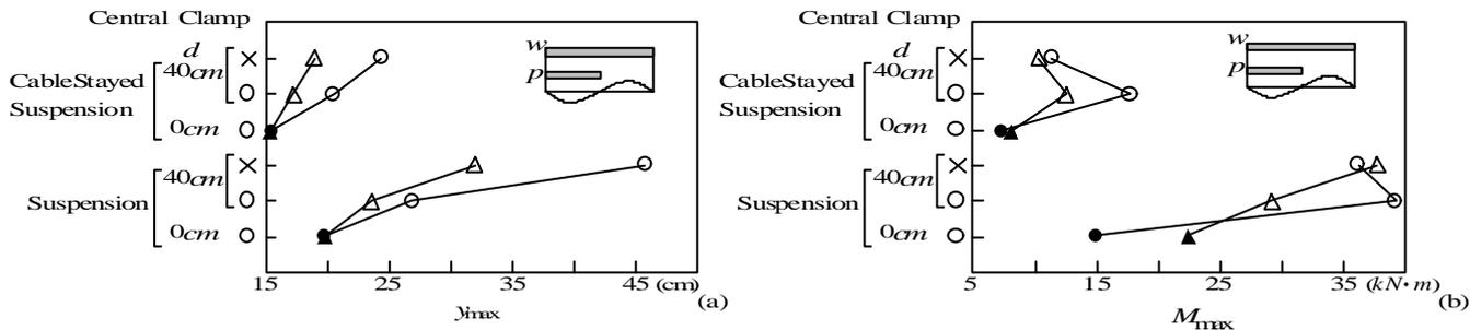
図-6 上ケーブル・主桁間距離  $d$  とセントラルクランプが  $y_{\text{max}}$  と  $M_{\text{max}}$  に及ぼす影響
