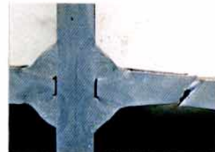
写真-3 引張試験の破断面
