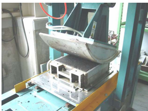
図 1 . アスファルト転圧状況
