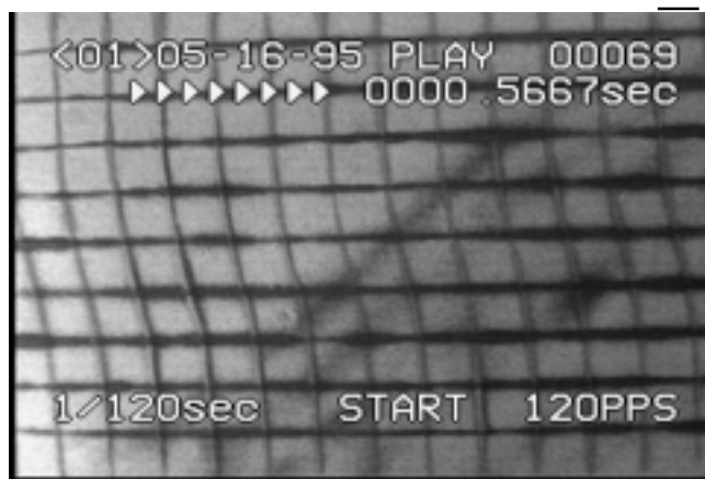
図3 高速で変位させた実験での地表の変形形状。地盤高さ12cm。
