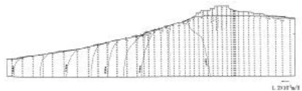
図－5（b）地下水流速ベクトル（断面）
