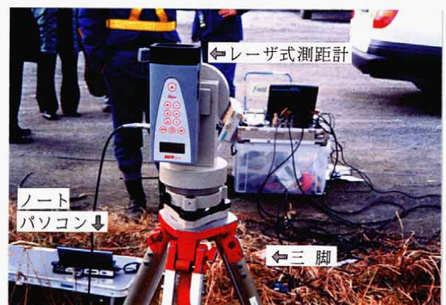
写真-3 非接触式たわみ測定器
