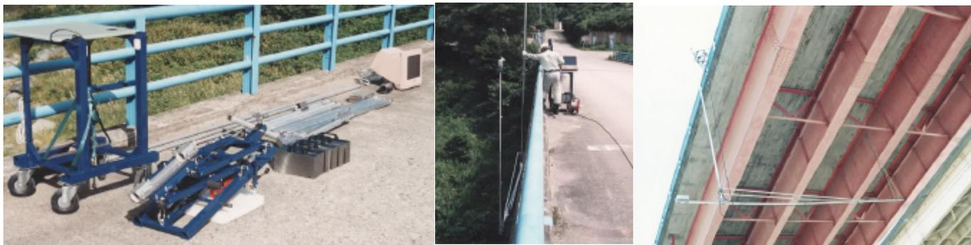
a) 点検装置の構成部材                      b) ポールの降下状況                      c) 床版下面の点検状況
