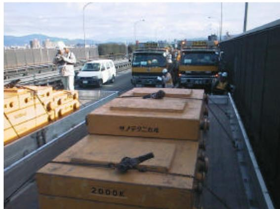
写真1 ブルーロード試験（50トン荷重車4台、計200トンの載荷）
