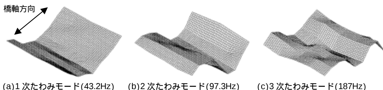
図 3. RC 床版振動モード形
