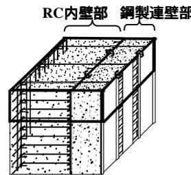
図-1 鋼製連壁の一体壁(水平方向断面)
