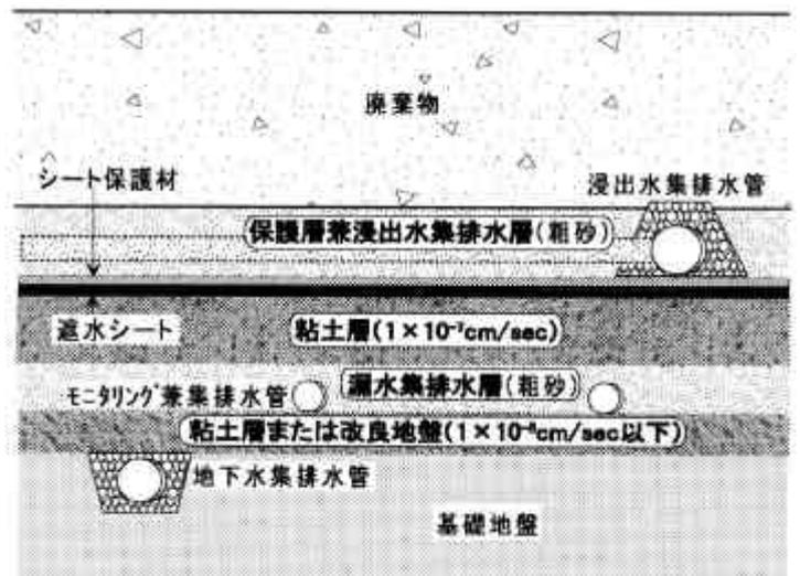
図 1 漏水監視システムを導入する構造断面
