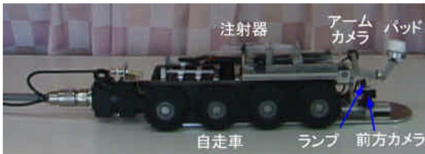
写真1 自走式サンプリング装置
