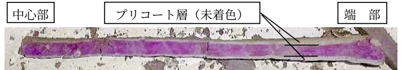
写真1 プリコート層形成状況(フェノールフタレイン溶液噴霧)
