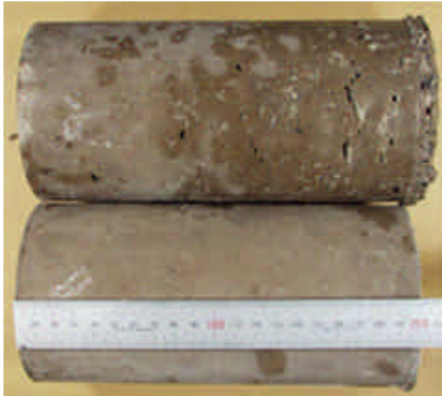
上：溶融スラグにより膨張した供試体 下：膨張抑制剤を添加した供試体
