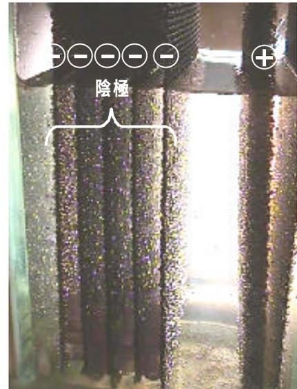
写真1 多重電極システム：水電解への適用例、陰極（左側5枚）からの $\text{H}_2$ 生成の様子
