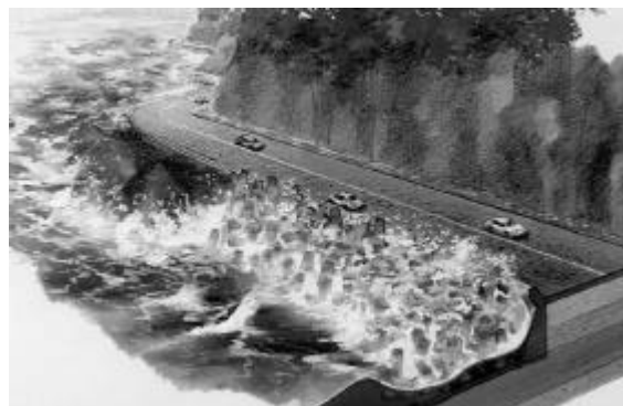
図-1 消波ブロック被覆護岸
