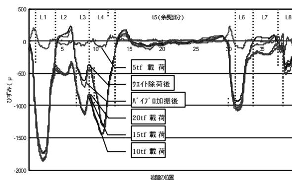
図 - 5 載荷加振実験後の光ファイバ歪計測値
