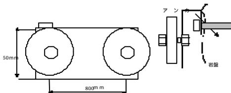
図 - 2 光ファイバ設置治具
