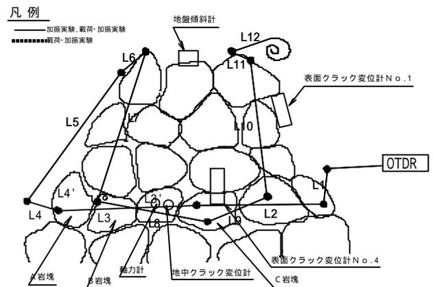
図 - 3 計測器配置図
