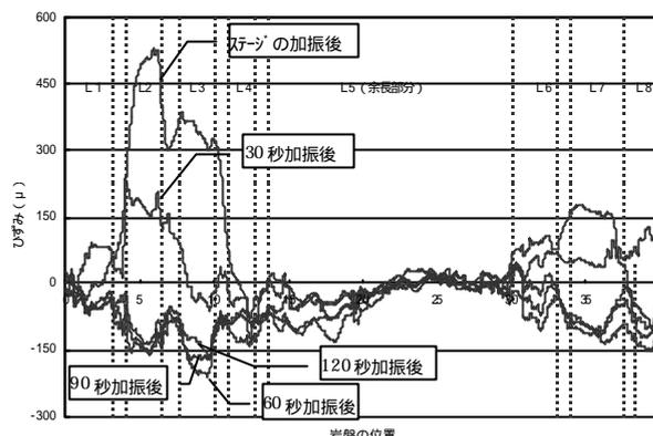
図 - 4 加振実験後の光ファイバ歪計測値
