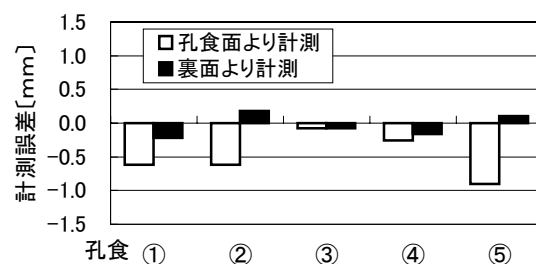
図-6 同一サンプル内の孔食の計測誤差例
