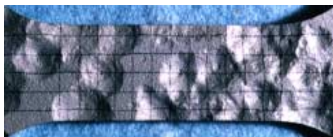
図-5 孔食サンプル材 No.1 表面外観写真 (錆を除去した状態)
