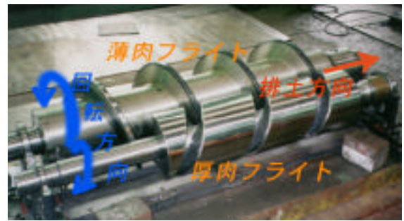
写真-1 ツインスクリュ組み合せ構造
