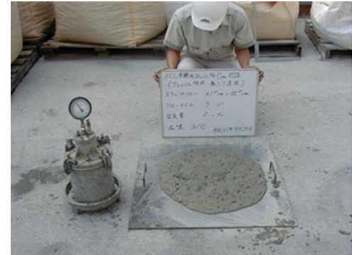
写真-1 スランプフロー試験状況
