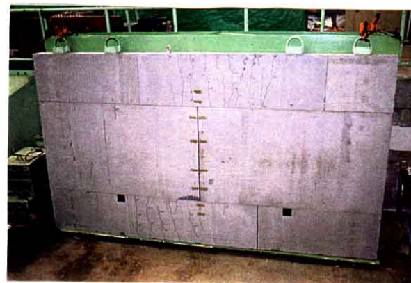
写真－2 添接曲げ試験 ひびわれ発生状況
