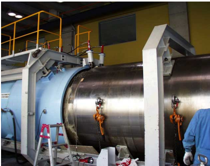
写真-1 テール部止水実験装置
