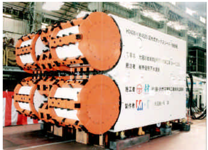
写真－1 泥水式ボックスシールド機
