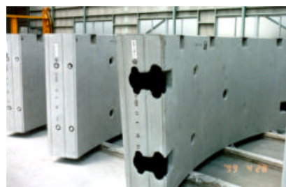
写真-1 拡幅セグメント (幅 1500mm, 桁高 400mm)
