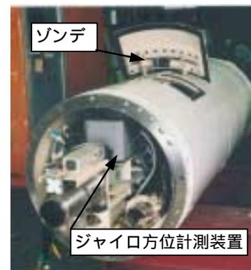
写真-2 計測装置設置状況
