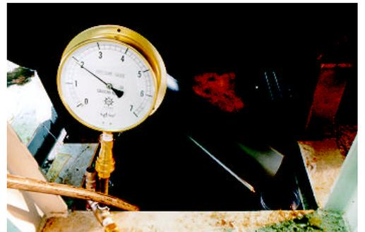
写真 - 2 止水性能確認状況(Step4の例)
