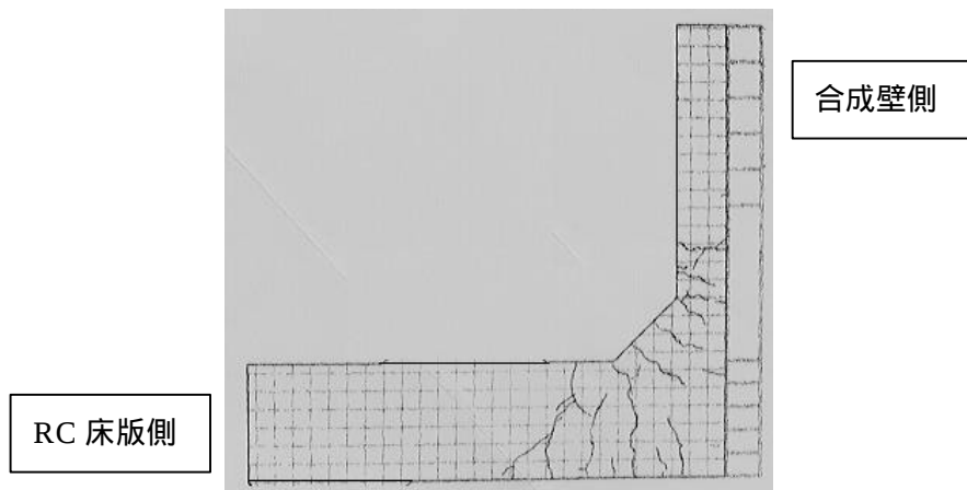
図-4 L2 終了後のひび割れ発生状況
