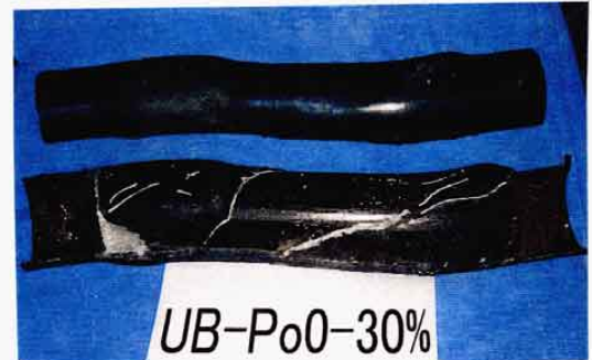
写真2 UB-P 0 -30%の破壊性状
