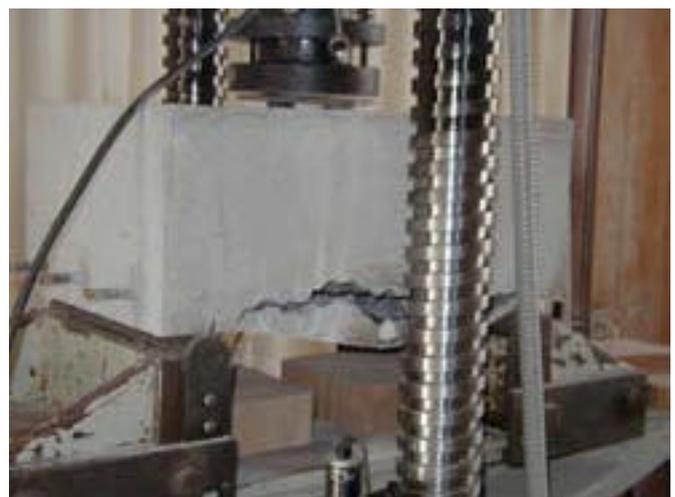
写真 1 繊維ネット供試体押し抜き載荷状況
