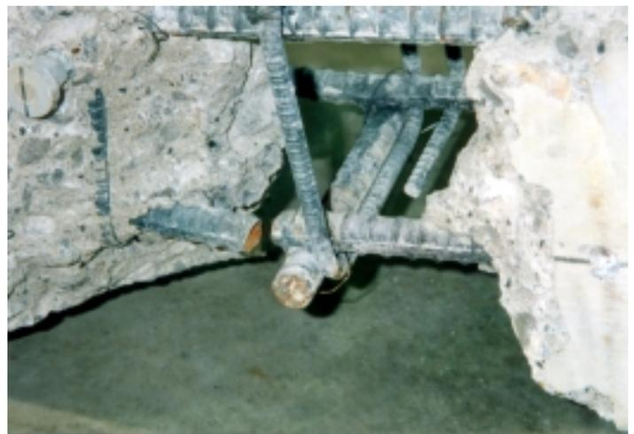
写真-1 溶接部の鉄筋破断状況
