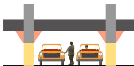
図-1 鋼製ハンチ + 鋼板巻き補強
