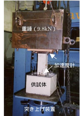
写真 1 衝撃的突き上げ実験
