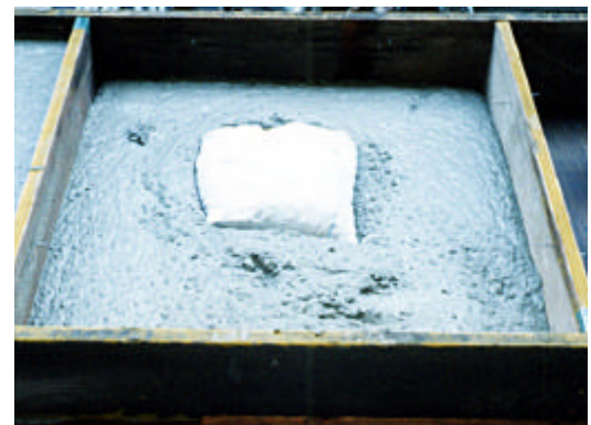
図2 ジャンカ模擬供試体
