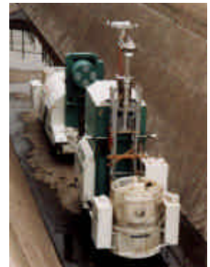
写真-1 小断面トンネル用 レーザ・レーダ計測車
