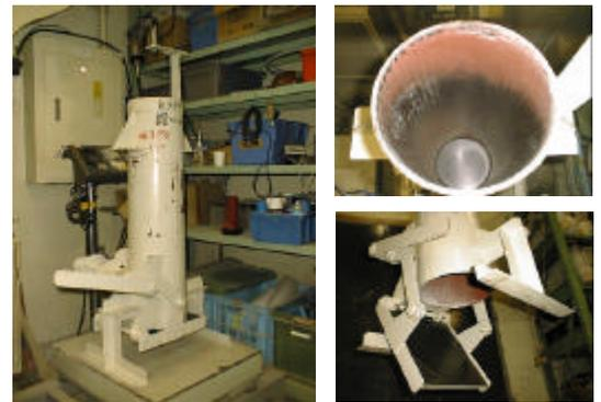
写真 - 1 水浸細骨材の計量容器
