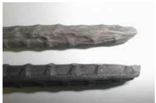
写真-1 鉄筋の断面欠損状況
