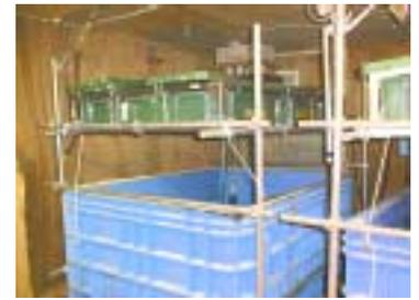
写真-1 降雨散布装置
