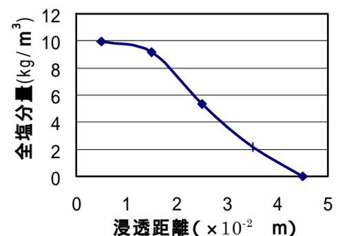
図1 全塩分量と浸透距離の関係 (自然暴露実験)
