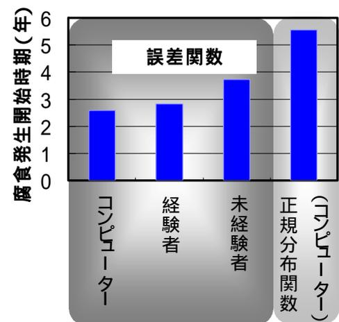
図4 鉄筋の腐食発生開始時期の予測結果
