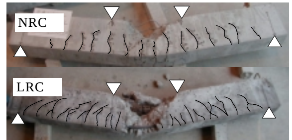
写真1 はりの破壊状態
