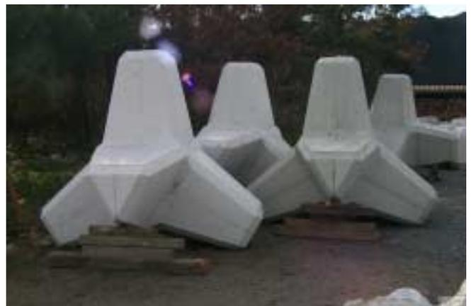
写真1. 予備処理スラグ固化体を利用した5t消波ブロック
