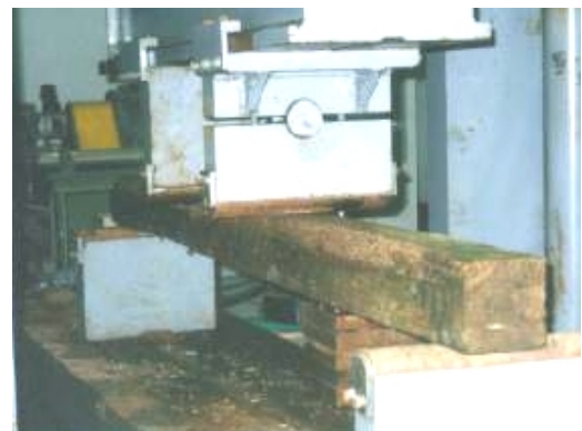
図 - 2 曲げ載荷状況（暴露後スギ NCU 処理）
