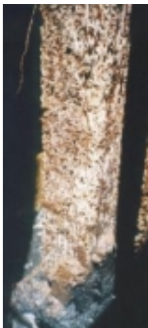
図 - 3 暴露後の無処理材 (左: ベイマツ, 右: スギ)
