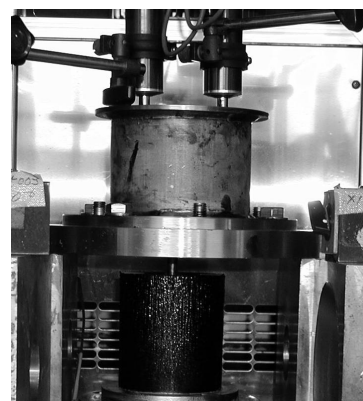
写真-1 変形特性試験(60℃, 試験が終了し、内型枠が抜けた状況)
