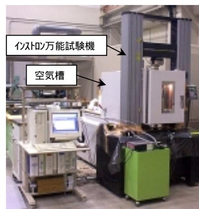
写真 - 1 間接引張試験装置の全景
