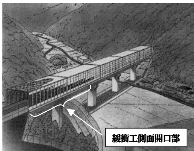
図－1 トンネル緩衝工の概略形状
