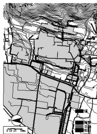
図2 地形・平場・道・擁壁レイヤーの重ね合わせ
