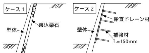
(a) 壁体 + 栗石 (b) 壁体 + 短補強材
