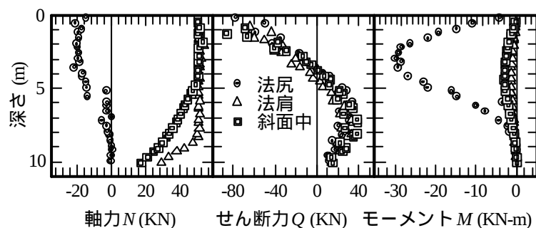
図—5 改良体の位置による N 、 Q および M の変化
