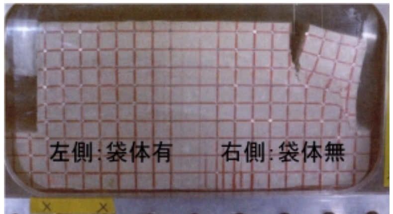
写真 1 試験時の地盤状況（中間土地盤，地盤強度中）
